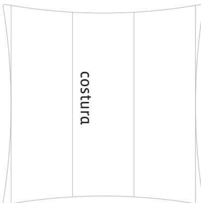
> Instalar primero extremo vértices extremos con costuras, en pilares más altos indicados en el plano y tensar hasta obtener costura derecha. NO AL MÁXIMO
