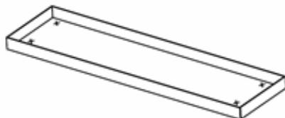
> Rellenar los 4 orificios creados en el suelo con resina anclaje o similar.
