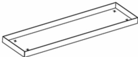
> Perforar el suelo y la tapa (diámetro de 20 mm) en los 4 puntos mostrados.
