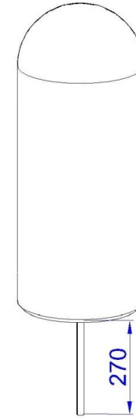
Vista Isométrica con anclaje
