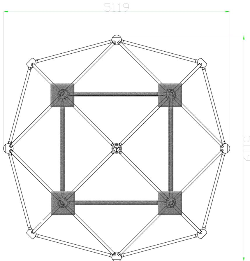
En la figura, se muestra tipo de fundación para superficie compacta en hormigón tipo H25 el cual debe ser vibrado para la instalación.
