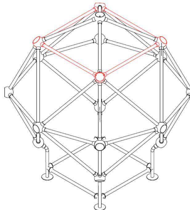
En la figura, se indica en color rojo, las esferas del tercer piso, y las cañerías que componen el anillo del mismo.
