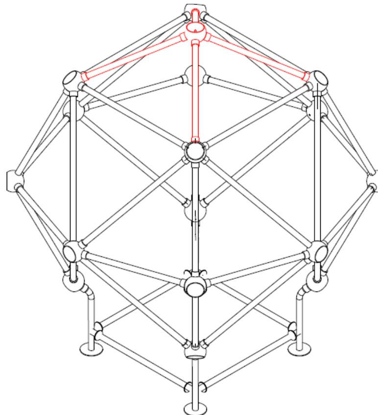
En la figura, se indica en color rojo, la esfera de la cúpula del último piso, y las cañerías que la conforman.
