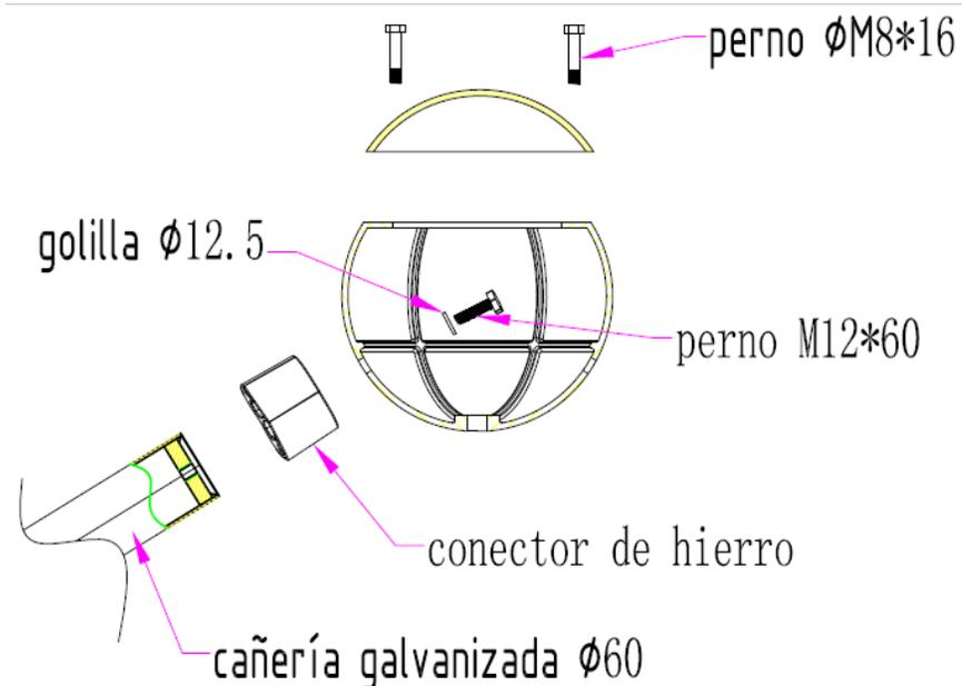
En la figura, se muestra el esquema de armado de las esferas conectoras, el cual incluye ahora las tapas plásticas.
