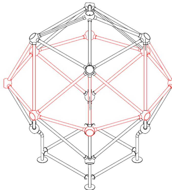
En la figura, se indica en color rojo, las esferas del segundo piso, y las cañerías que componen el anillo, las verticales, y diagonales para el tercer piso.
