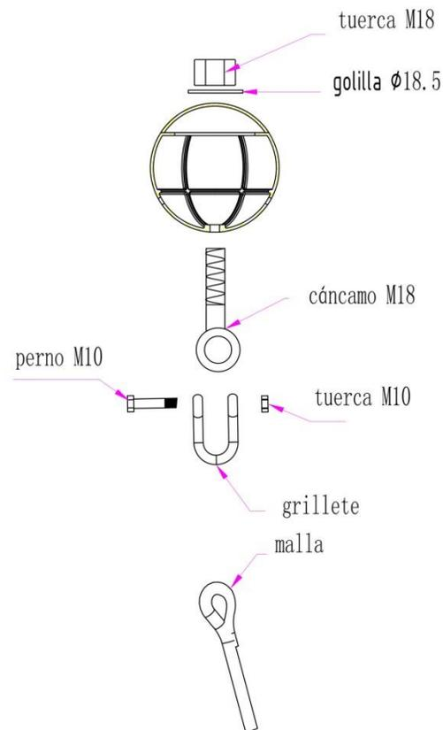
En la figura, se presenta el esquema de armado de los componentes de los conectores de la malla hacia las esferas conectoras.
