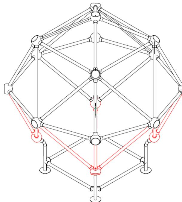
En la figura, se indica en color rojo, las esferas del nivel base, y las cañerías donde se encajarán las esferas del segundo piso.
