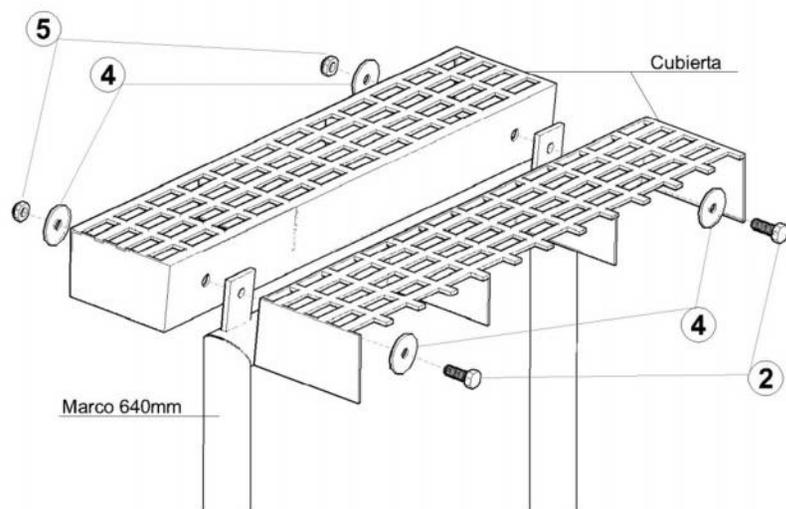
Finalmente instale el Marco de 540mm por el interior de la cubierta y fíjelo mediante pernos indicados a continuación.
