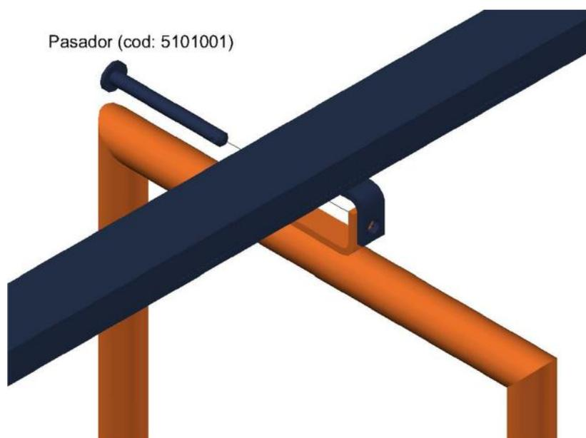
Finalmente fijelo mediante los pernos indicado en la siguiente imagen.
